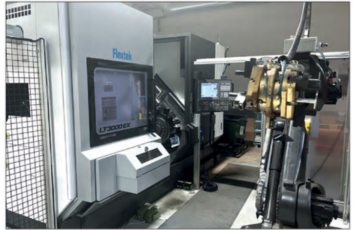
Maskinfabrikken Eskos seneste investering er et Okuma LT3000EX CNC-drejecenter, som Flextek A/S har stået for leveringen af, såvel som udviklingen af en værktøjssoftware, der yderligere øger produktiviteten i produktionscellen med robot.
